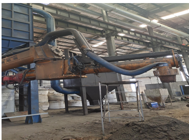
呖喃树脂砂造型工序集气管道+ 自带布袋除尘器
