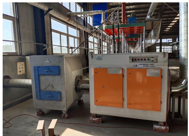
预发泡+熟化+加热成型+白膜烘干工序 UV 光氧+活性炭吸附装置
