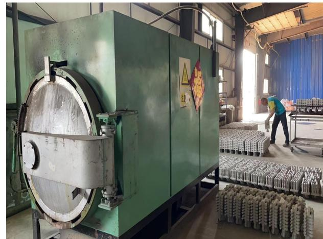
精密铸造车间脱蜡工序密闭进行
