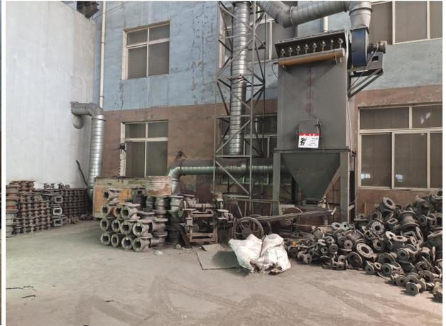
覆膜砂 1 车间造芯工序 UV 光氧装置+活性炭吸附装置、人工打磨工序布袋除尘器
