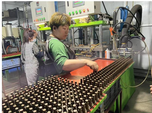
精密铸造车间压制蜡型工序密闭进行
