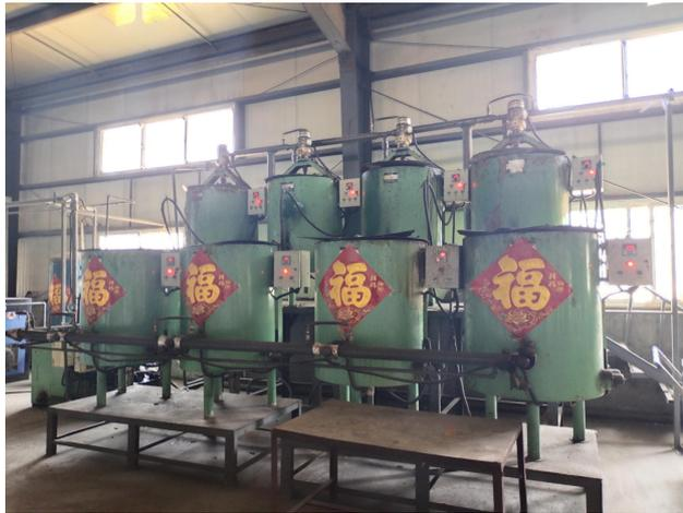
精密铸造车间石蜡熔化工序密闭进行
