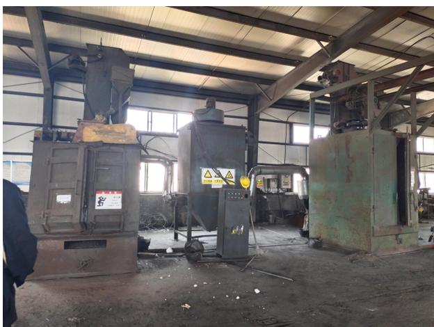
铸铁 2 车间密闭抛丸机+布袋除尘器 1
